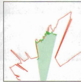
Sichtweise: So „sieht“ der Roboter Gegenstände. Rot sind die Daten von den Lasersensoren, grün jene von den Stereokameras. Die entscheidenden Punkte überlappen sich.
