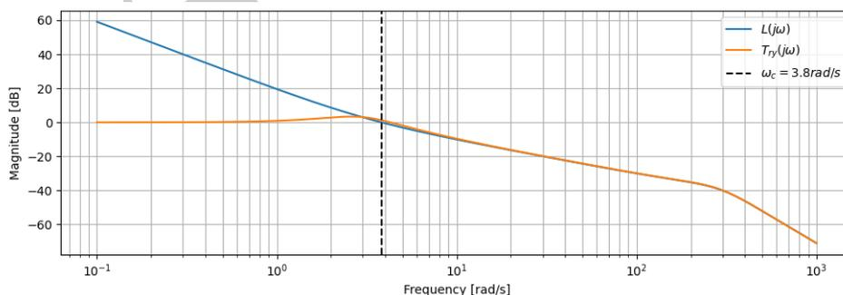
Abbildung 3: Betragsfrequenzgang der Übertragungsfunktion des geschlossenen Regelkreises  $T_{ry}(s)$
