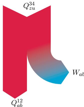
Abbildung 3.10: Sankey-Diagramm der Carnot-Maschine.
