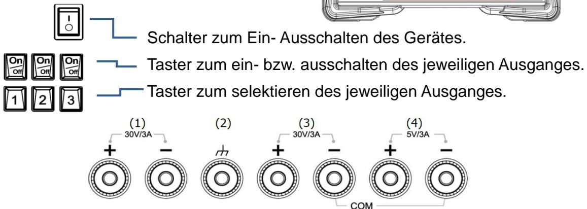
Geräteausgänge: 1, 3, und 4 sind die einzelnen Ausgangskanäle. 2 ist der Erdungsanschluss der auch mit dem Gehäuse des Geräts verbunden ist.
