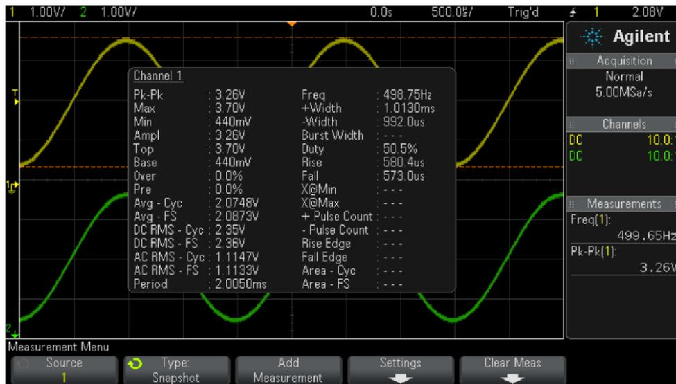
Mittels Quelle (**Source**) kann der zu messende Kanal eingestellt werden und mittels **Type** kann die Messgröße ausgewählt werden. **Add Measurement** und **Clear Meas** fügen Messgrößen zur Auswahl hinzu bzw. entfernen diese.
