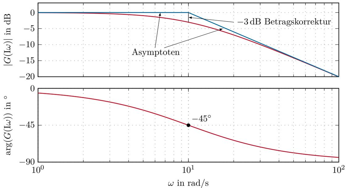
Abbildung 3.16: Bode-Diagramm für einen linearen Term im Nenner.
