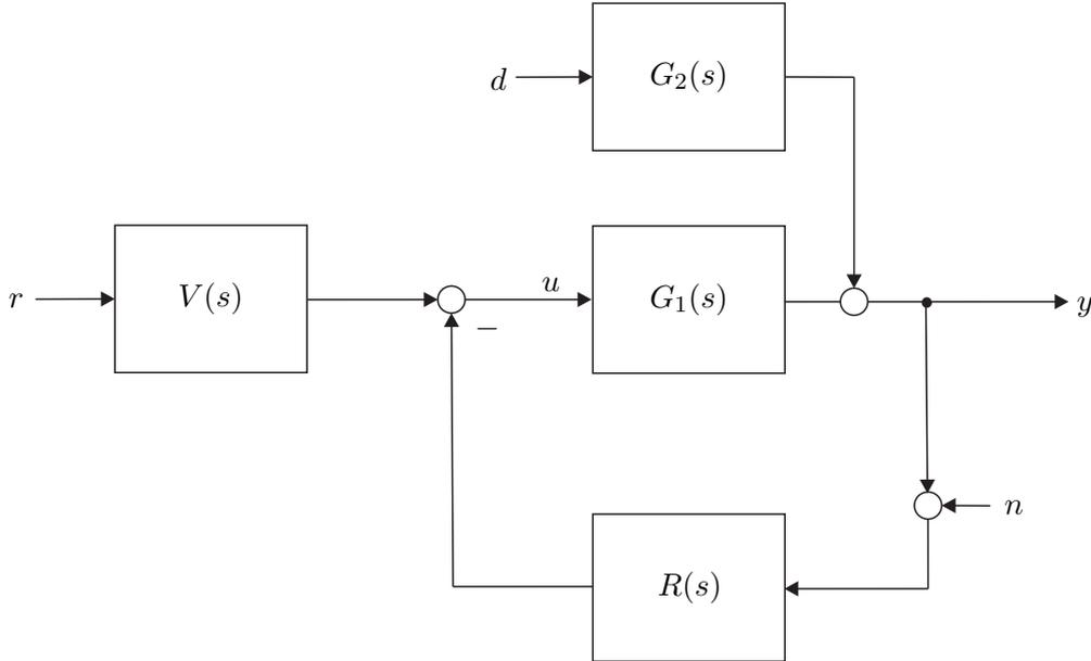
Abbildung 3.9: Regelkreis mit zwei Freiheitsgraden.
