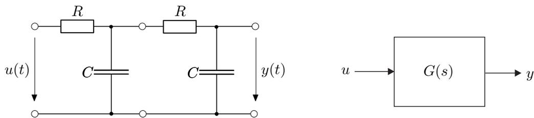
Abbildung 3.4: Elektrisches Netzwerk.
