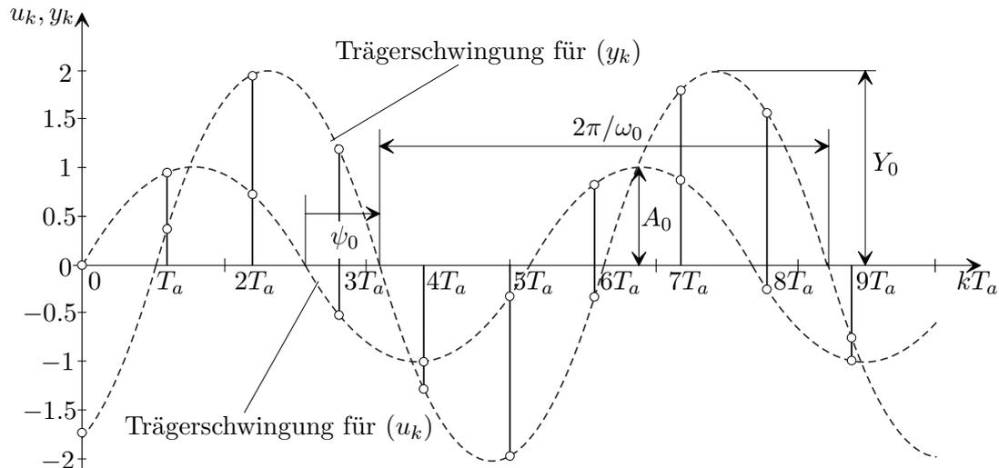
Abbildung 6.9: Zum diskreten Frequenzgang.
