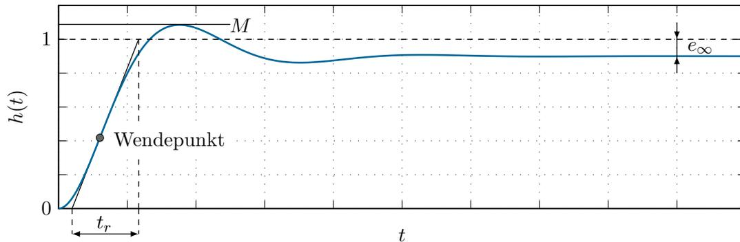
Abbildung 5.2: Kenngrößen der Sprungantwort des geschlossenen Kreises.
