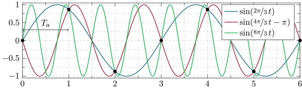
Abbildung 6.10: Mehrdeutige Zuordnung zwischen Folgenwerten und Trägerschwingung.
