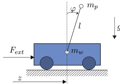
Abbildung 7.2: Wagen mit inversem Pendel.
