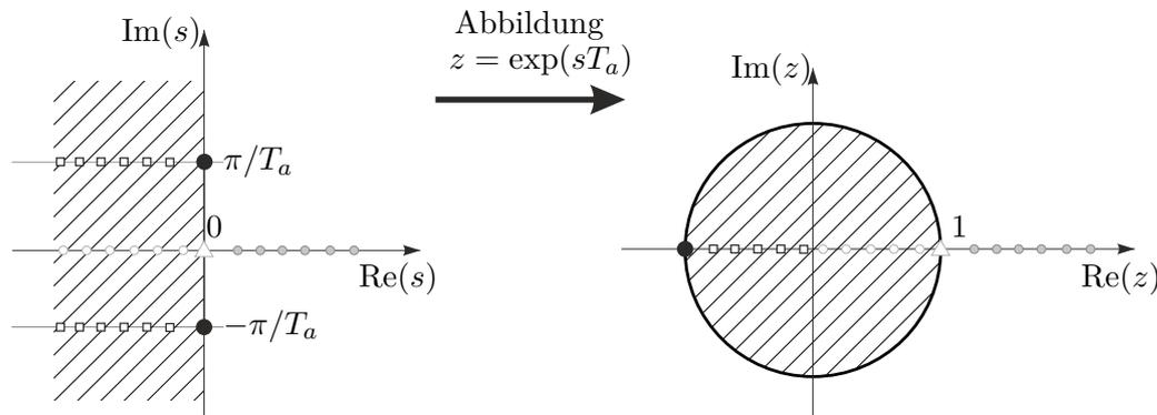
Abbildung 6.6: Die konforme Abbildung  $z = \exp(sT_a)$ .
