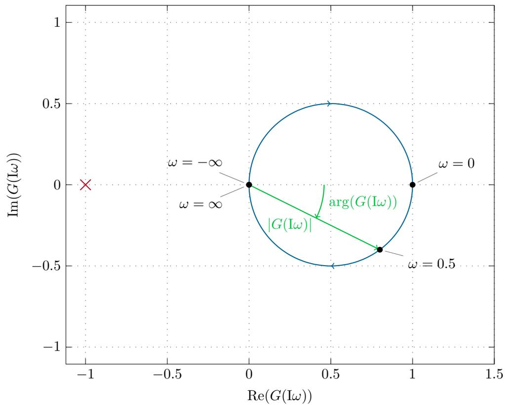
Abbildung 3.14: Nyquist-Ortskurve der Übertragungsfunktion von Abbildung 3.12.
