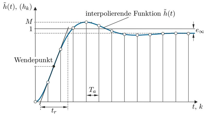
Abbildung 6.19: Kenngrößen der Sprungantwort des geschlossenen Kreises.
