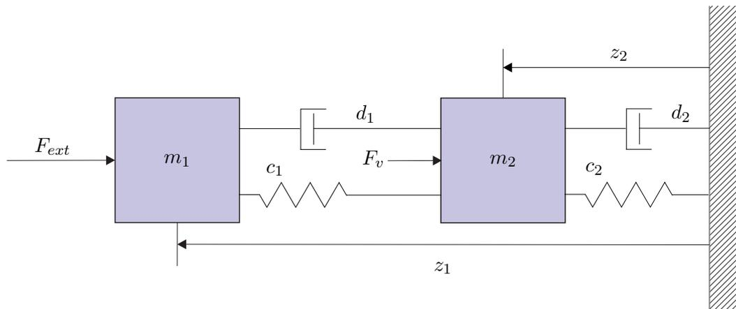
Abbildung 8.1: Zweimassenschwinger.
