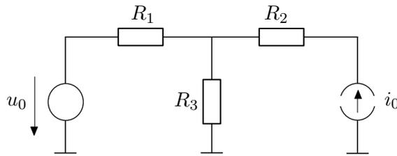
Abbildung 2.2: Einfaches Netzwerk mit Strom- und Spannungsquelle.
