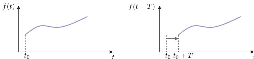
Abbildung 2.3: Zur Verschiebung einer Zeitfunktion.
