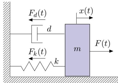
Abbildung 1.7: Einfaches Feder-Masse-Dämpfer System.
