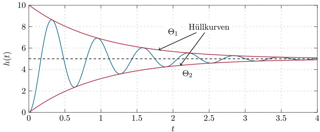
Abbildung 3.22: Die Hüllkurven der Sprungantwort eines P-T<sub>2</sub>-Gliedes.
