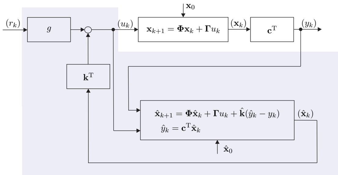
Abbildung 8.3: Zustandsregler/Zustandsbeobachter Konfiguration.
