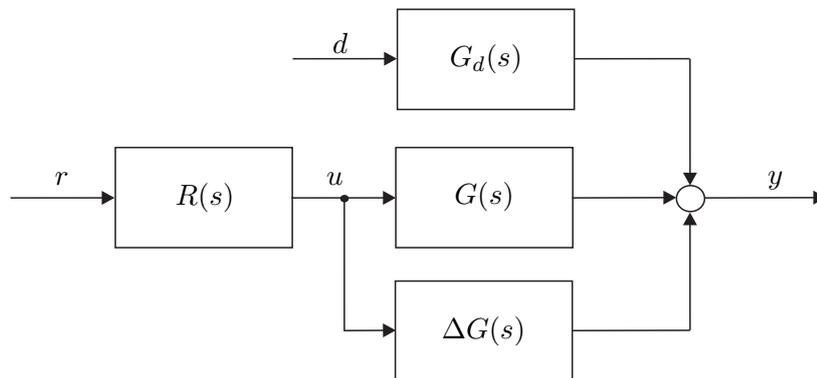
Abbildung 4.6: Einfache Steuerung.
