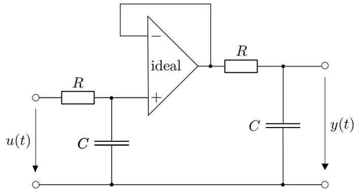
Abbildung 3.6: Auftrennung der Teilnetzwerke durch einen Spannungsfolger.
