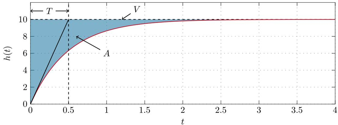
Abbildung 3.20: Sprungantwort eines P-T<sub>1</sub>-Gliedes.
