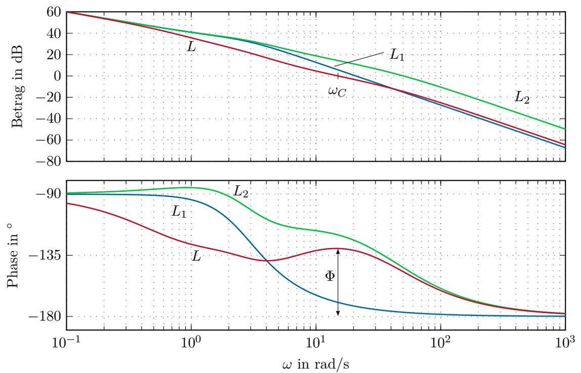
Abbildung 5.5: Bode-Diagramme des offenen Kreises  $L_1(s)$  und  $L(s)$ .
