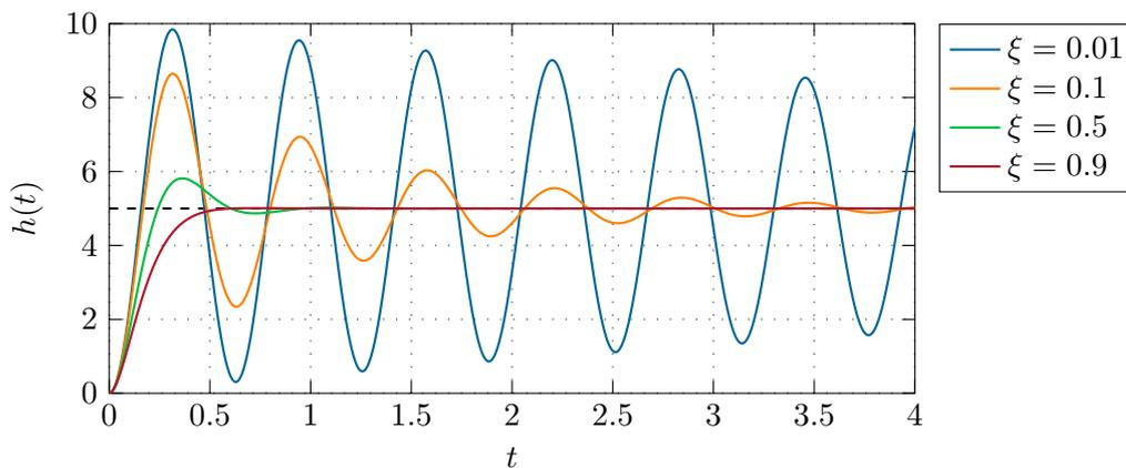
Abbildung 3.21: Sprungantwort eines P-T<sub>2</sub>-Gliedes.
