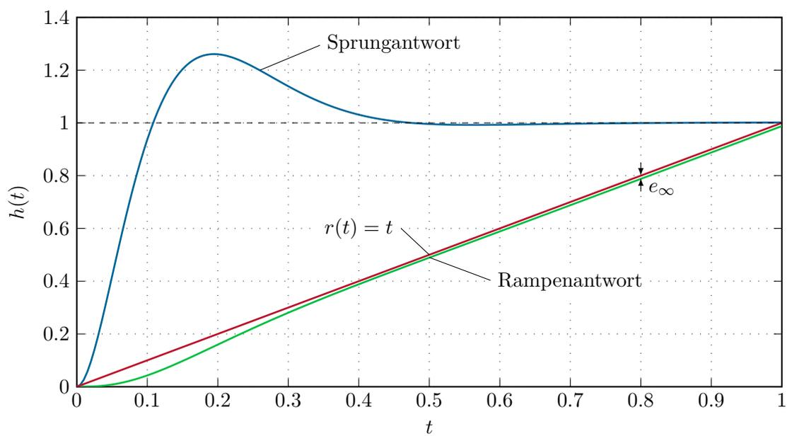
Abbildung 5.6: Sprung- und Rampenantwort des geschlossenen Kreises.
