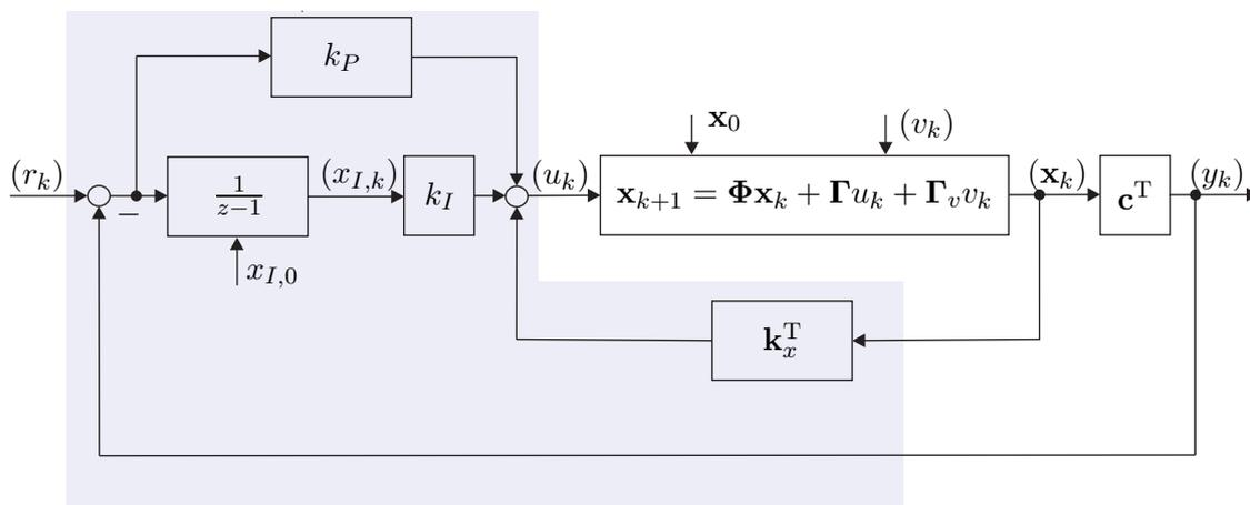
Abbildung 8.2: Blockschaltbild zum PI-Zustandsregler für den zeitdiskreten Fall.
