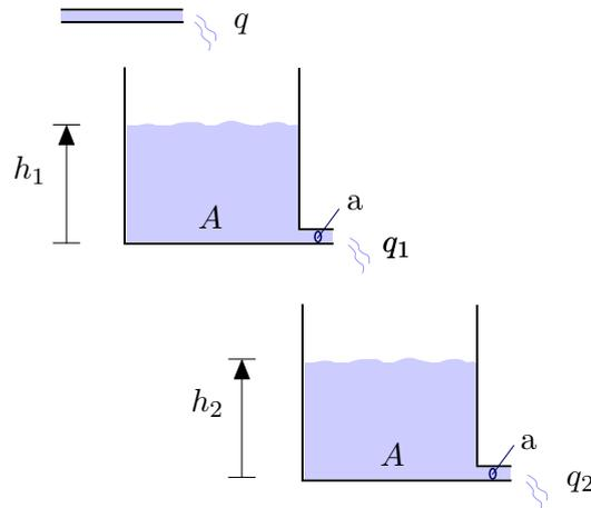
Abbildung 1.11: Zwei-Tank-System.
