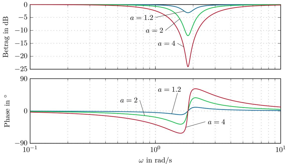
Abbildung 5.9: Bode-Diagramm eines Notchfilters zur Kompensation der Resonanzfrequenz.
