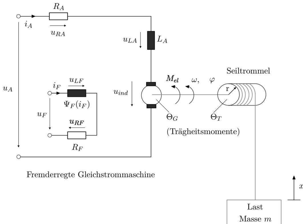
Abbildung 1.9: Fremderregte Gleichstrommaschine mit Seiltrommel und Last.
