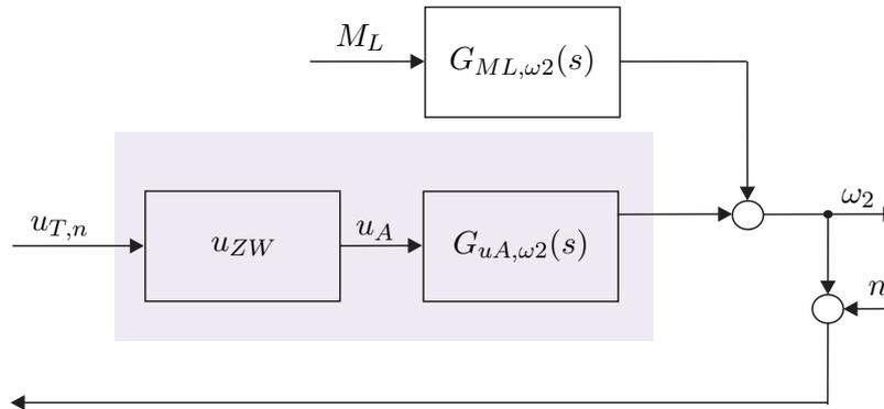
Abbildung 4.4: Äquivalentes Übertragungssystem zur Antriebsregelstrecke von Abbildung 4.2.
