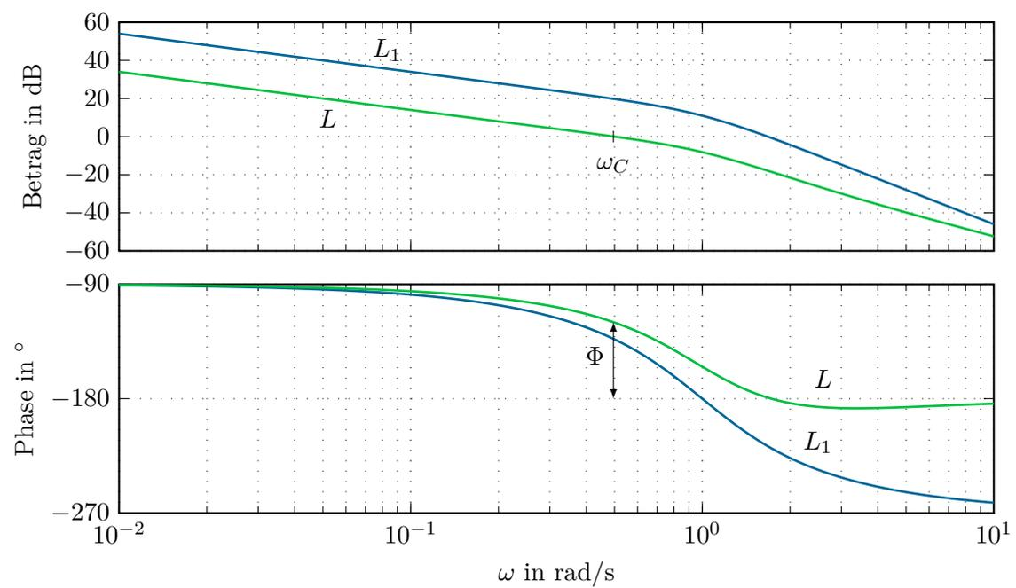
Abbildung 5.3: Bode-Diagramme des offenen Kreises  $L_1(s)$  und  $L(s)$ .
