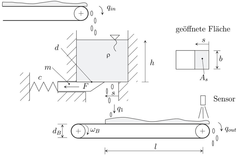
Abbildung 1: Skizze des Transportsystems mit Zwischenspeicher
