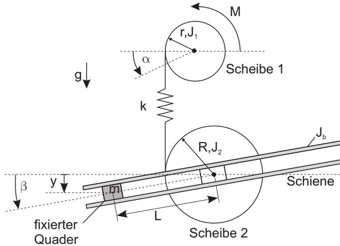
Abbildung 1: Mechanisches System
