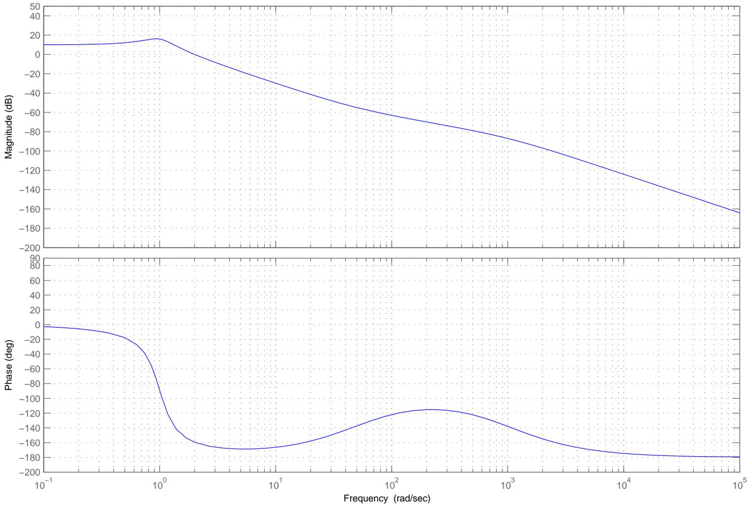
Abbildung 2: Bode-Diagramm des offenen Kreises zu Aufgabe 4 b).
