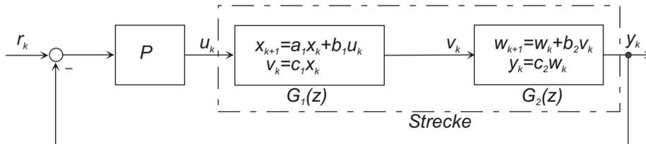
Die Strecke wird mit einem  $P$ -Regler geregelt. Geben Sie mit Hilfe des Jury-Schemas Bedingungen dafür an, in welchem Wertebereich der Parameter  $P$  eingestellt werden darf, damit die Führungsübertragungsfunktion  $T_{r,y}(z)$  des Regelkreises BIBO-stabil ist. Berechnen Sie dazu zunächst die Übertragungsfunktion  $G(z) = \frac{y_z(z)}{u_z(z)}$  der Strecke und setzen Sie dann die folgenden Parameter ein.
