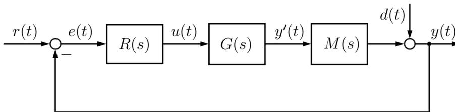
Abbildung 2: Regelkreis mit einem Freiheitsgrad.
