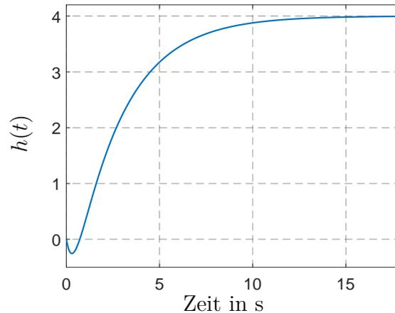
Abbildung 2: Sprungantwort  $h(t)$  eines linearen zeitinvarianten Systems.
