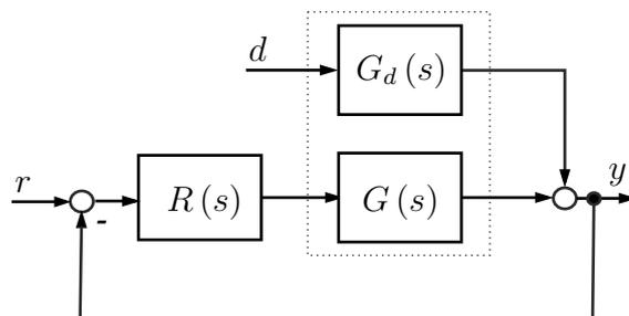
Abbildung 1: Einschleifiger Standardregelkreis.
