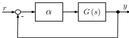
Abbildung 2: Einschleifiger Standardregelkreis.
