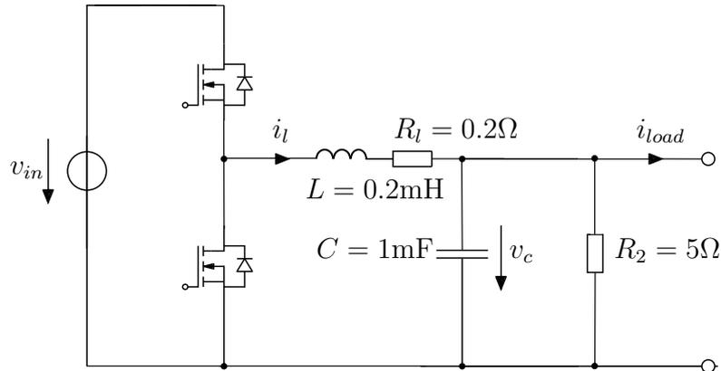
Abbildung 1: Topologie des einphasigen Buck Converters
