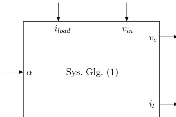
Abbildung 2: Struktur der Strecke für das Blockschaltbild
