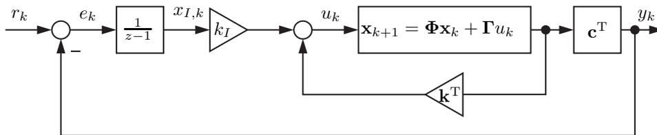
Abbildung 5: Zustandsregler mit Integrator.
