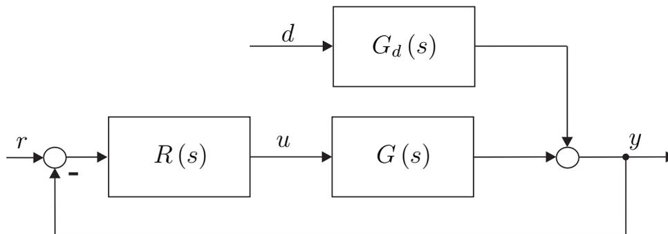
Abbildung 1: Regelkreis mit einem Freiheitsgrad
