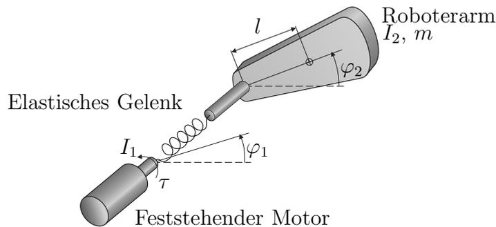
Abbildung 3: Elastisch angetriebener Roboterarm.
