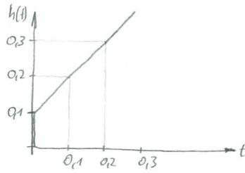
Abbildung 4: PI Regler mit  $h(0) = 0.1$ , Steigung ab  $t = 0$  ist 1;
