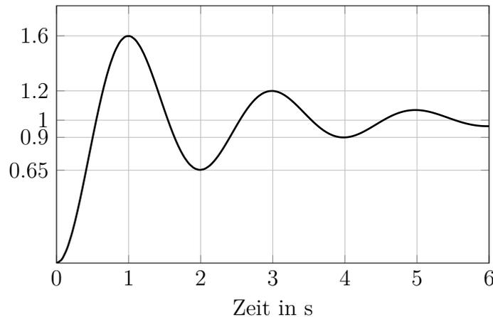
Abbildung 2: Sprungantwort eines linearen zeitinvarianten Systems  $G(s)$ .
