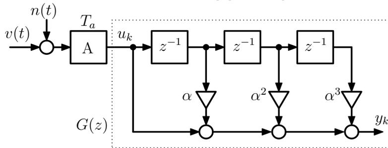
Abbildung 3: Blockschaltbild des FIR Filters.
