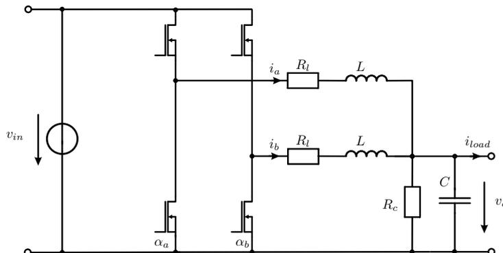
Abbildung 2: Topologie des zweiphasigen Buck Converters.
