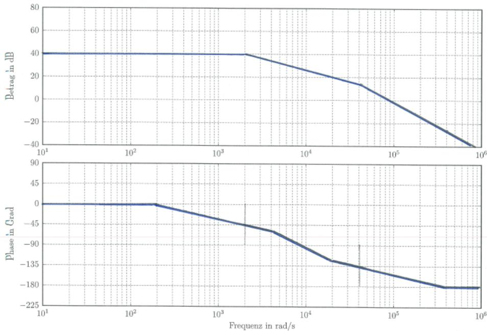
d) Entwerfen Sie für  $G_{v_c, \alpha_\Sigma}(s)$  von (2) einen zeitkontinuierlichen PI-Regler  $R(s)$  zur Spannungsregelung von  $v_c$  mithilfe des Frequenzkennlinienverfahrens, welcher folgende Anforderungen erfüllt
