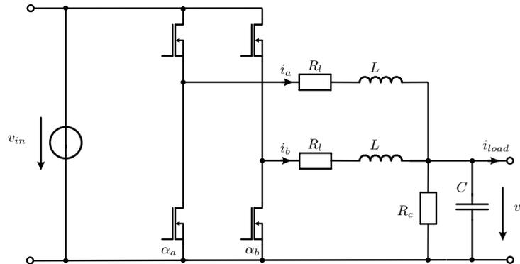
Abbildung 2: Topologie des zweiphasigen Buck Converters.
