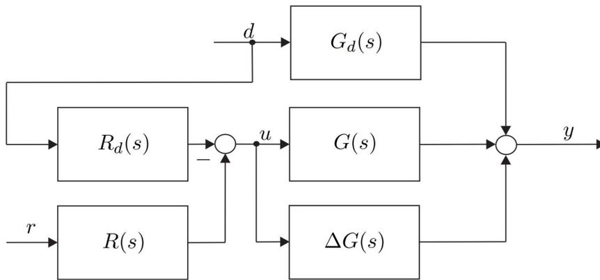
Abbildung 5: Blockschaltbild einer Steuerung mit Störgrößenaufschaltung.
