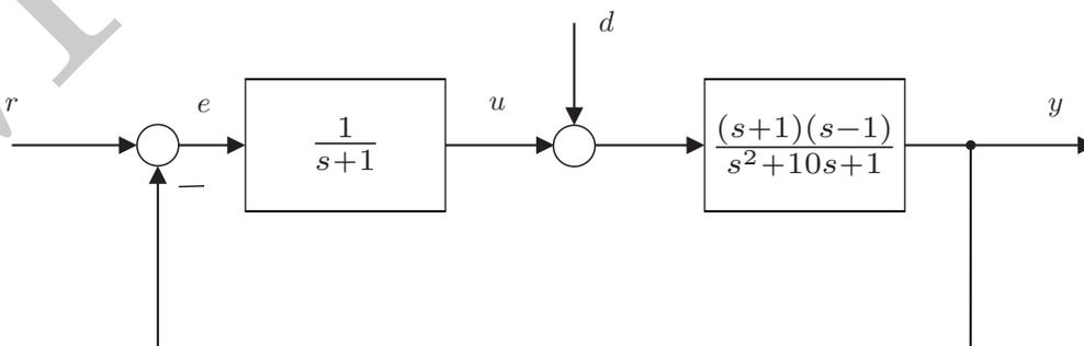
Abbildung 1: Blockschaltbild eines Regelkreises
