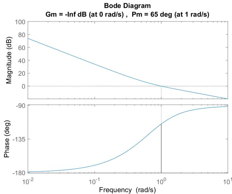
Abbildung 6: Bode-Diagramm des offenen Regelkreises aus Aufgabe 4b).
