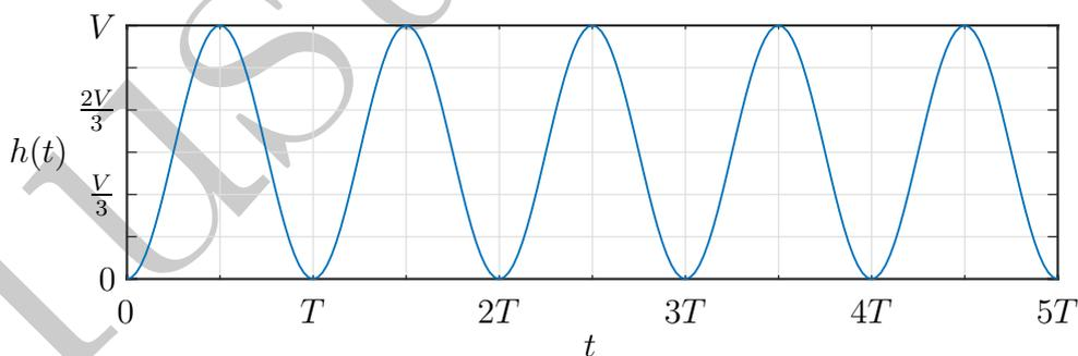
Abbildung 5: Sprungantwort einer Übertragungsfunktion 2-ter Ordnung.
