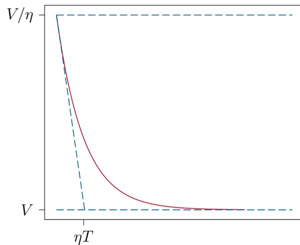
Abbildung 2: Sprungantwort der Reglerübertragungsfunktion  $R(s)$
