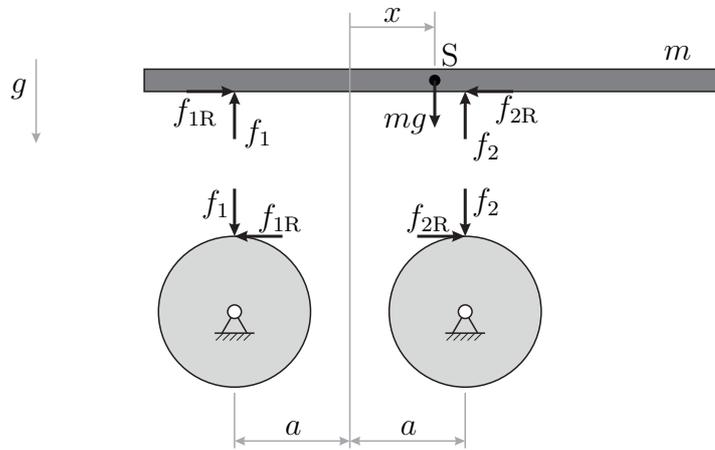
Abbildung 4: Brett auf zwei entgegengesetzt rotierenden Walzen, freigeschnitten.
