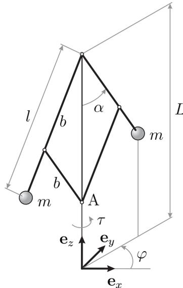
Abbildung 2: Schematische Darstellung eines Fliehkraftreglers.
