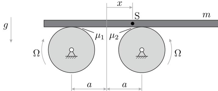
Abbildung 3: Brett auf zwei entgegengesetzt rotierenden Walzen.
