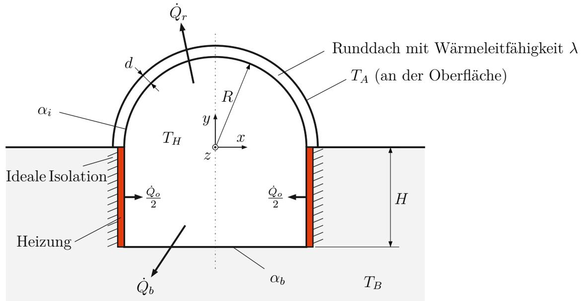
Abbildung 2: Thermisch isoliertes Marshabitat.
