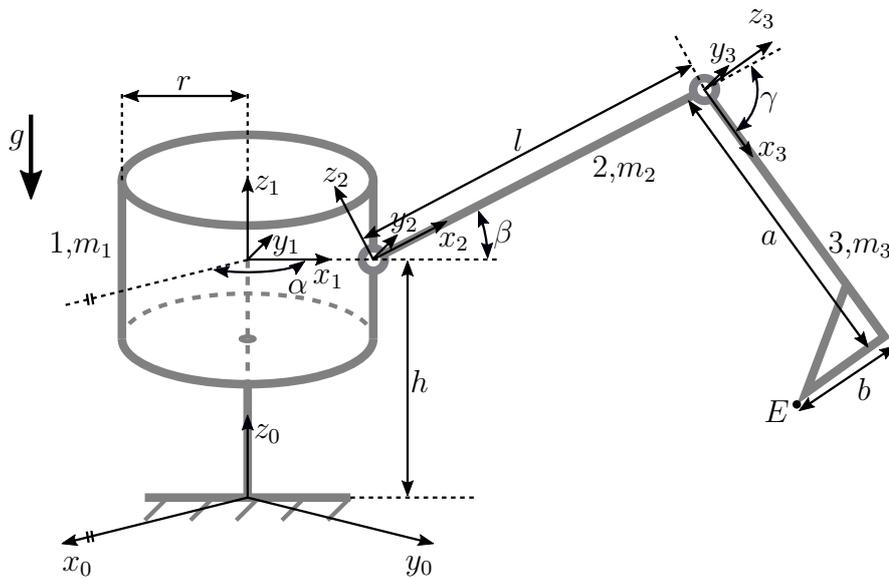
Abbildung 3: Modell eines Schaufelbaggers: Drehturm und Arm.
