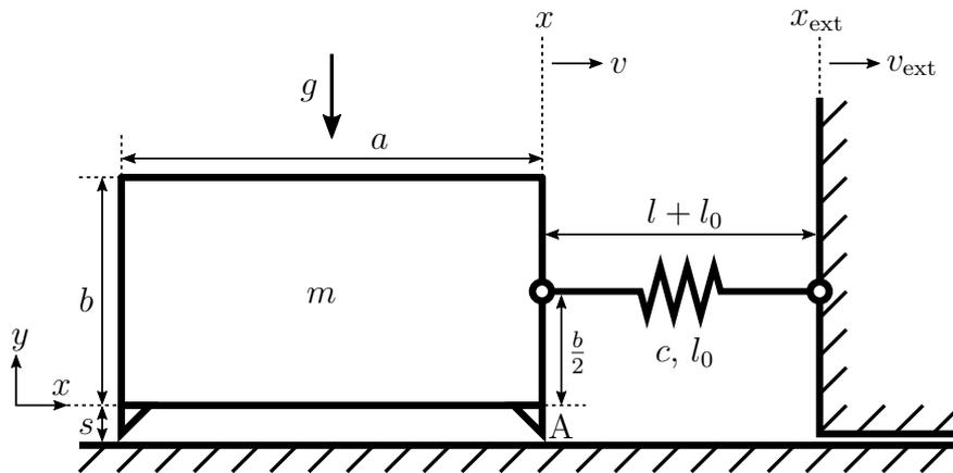
Abbildung 2: Block, Feder und ziehender Körper.
