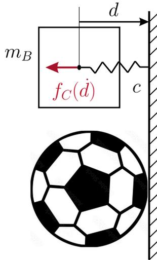
Abbildung 6: Modell der Interaktion des Balles mit der Latte.
