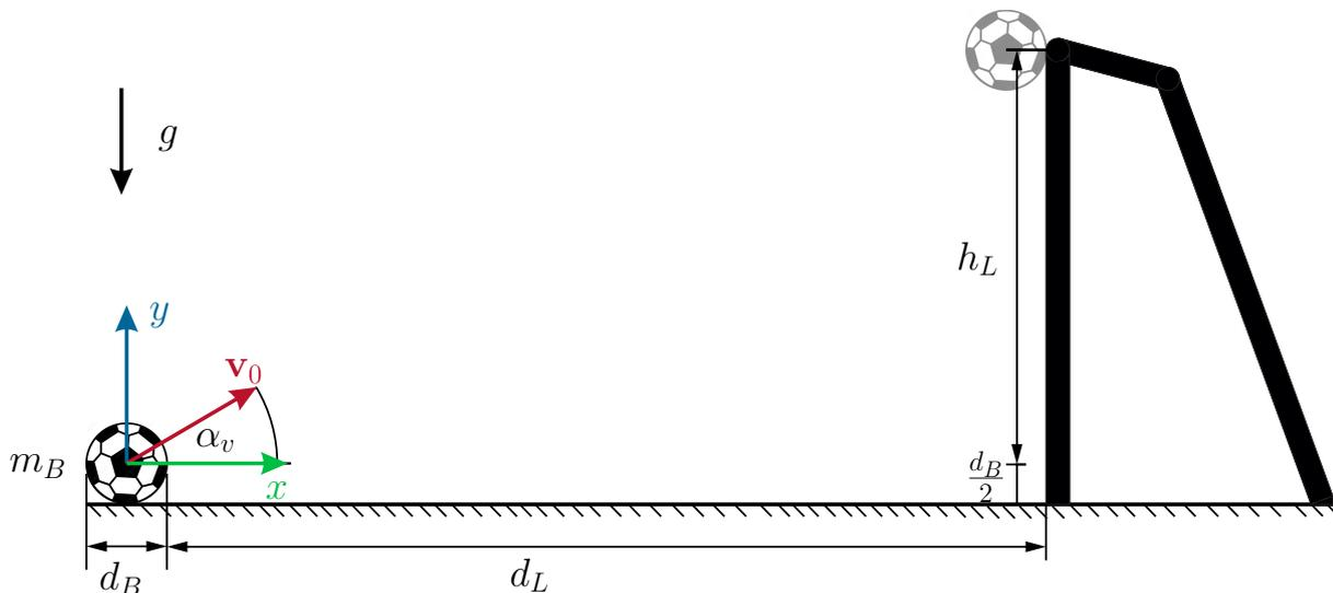
Abbildung 5: Modell des Balls während des Schusses.
