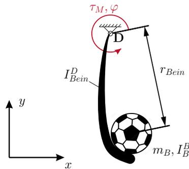
Abbildung 4: Schematisches Modell eines Balles während des Tretens.
