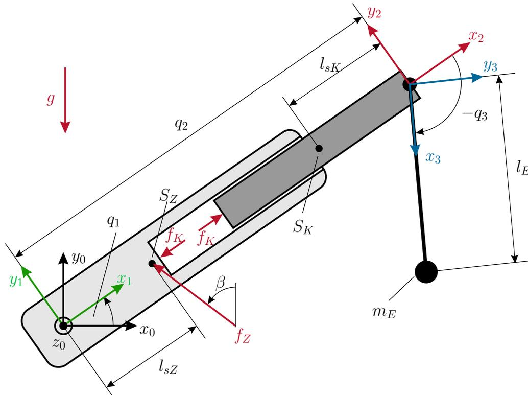
Abbildung 3: Planare Darstellung des Starrkörpersystems.
