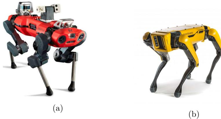
Abbildung 1.13: Beispiele für vierbeinige Laufroboter. (a) ANYmal (ANYbotics), (b) Spot Mini (Boston Dynamics)
