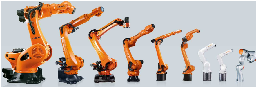
Abbildung 1.5: Industrieroboter in unterschiedlichen Baugrößen. Die Roboter unterscheiden sich in der maximalen Traglast, Reichweite sowie maximale Beschleunigungen und Geschwindigkeiten am Endeffektor.
