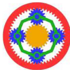
Abbildung 2.15: Konzeptskizze eines Planetengetriebes bestehend aus einem zentralen Sonnenrad (gelb), vier Planetenrädern (blau) und einem Hohlrad (rot) (Wikipedia). Die Umlaufbewegung der Planetenräder wird an den Steg (grün) abgegeben. Grundsätzlich kann entweder das Sonnenrad, das Hohlrad, oder der Steg feststehend sein, während sich die anderen beiden Komponenten mit unterschiedlichen Drehgeschwindigkeiten gegeneinander bewegen.
