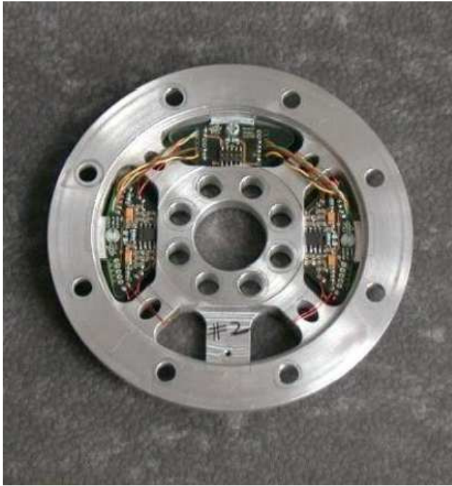
Abbildung 2.5: Links: Drehmomentsensor in den Gelenken des DLR Leichtbauroboters [2.3]. Durch eine äußere Krafteinwirkung kommt es zu einer Verdrehung zwischen dem inneren und äußeren Ring. Diese Verdrehung wird über die in den Stegen integrierten DMS erfasst. Rechts: Auswertung eines DMS über eine Wheatstone-Brückenschaltung [2.1].
